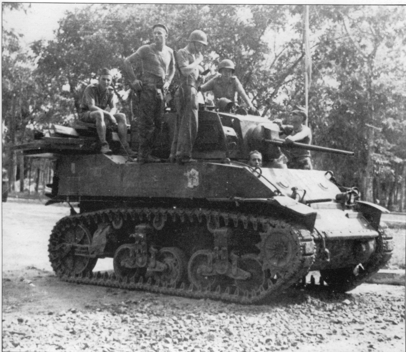
Page de gauche, en haut : — Le CL 1 s'installe à Tan An, d'où il va rayonner pour nettoyer le secteur ; en bas : — Rebelle capturé (Photos CLI). Ci-dessus : — Char léger M5 de la 2 e DB. Ses mitrailleuses de 30 et son canon de 37 mm en font un engin redoutable face aux résistances frontales, mais le paysage de rizières le rive sur les routes. Ci-contre : — A la résidence de Tan An, le commandant Lacroix, commandant le commando léger n° 1 du CLI-5 e RIC (Photos CLI). Ci-dessous : — Ambulances des « Rochambelles » de la 2 e DB franchissant une zone dont les coupures ont été rebouchées (Photo Fonds Leclerc).
